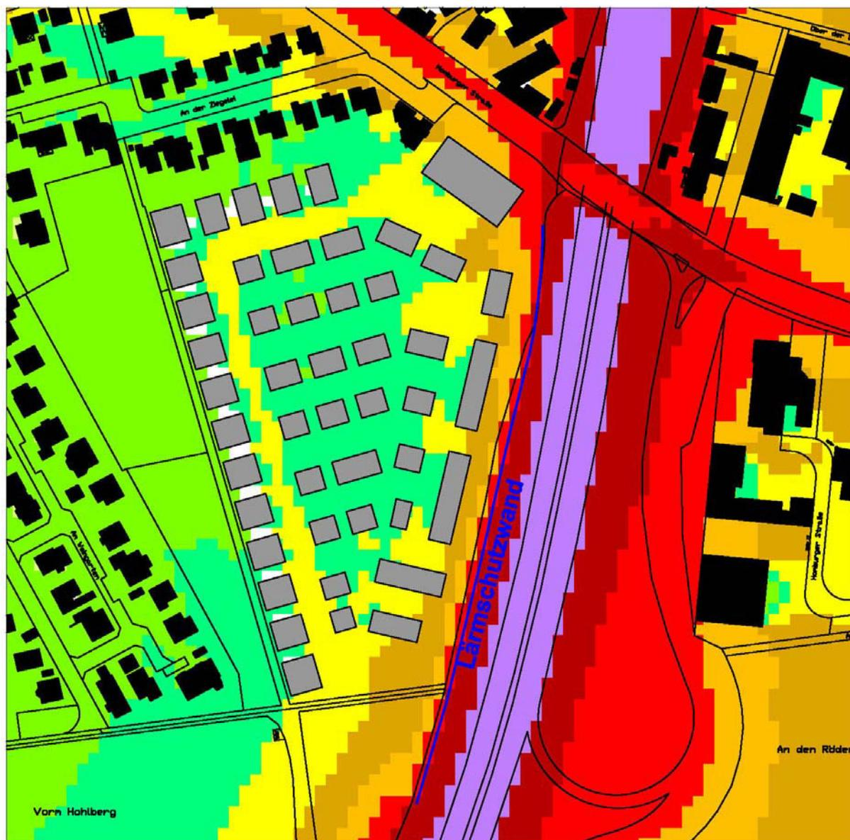
Abb. 9: Schallausbreitung nachts bei 5 m hoher Lärmschutzwand
