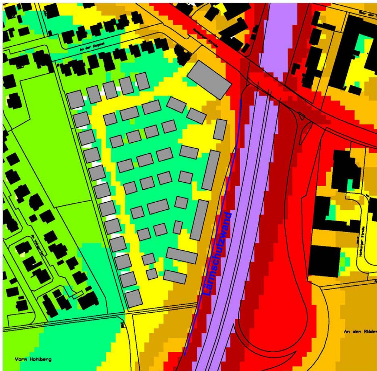
Abb. 11: Schallausbreitung nachts bei 6 m hoher Lärmschutzwand
