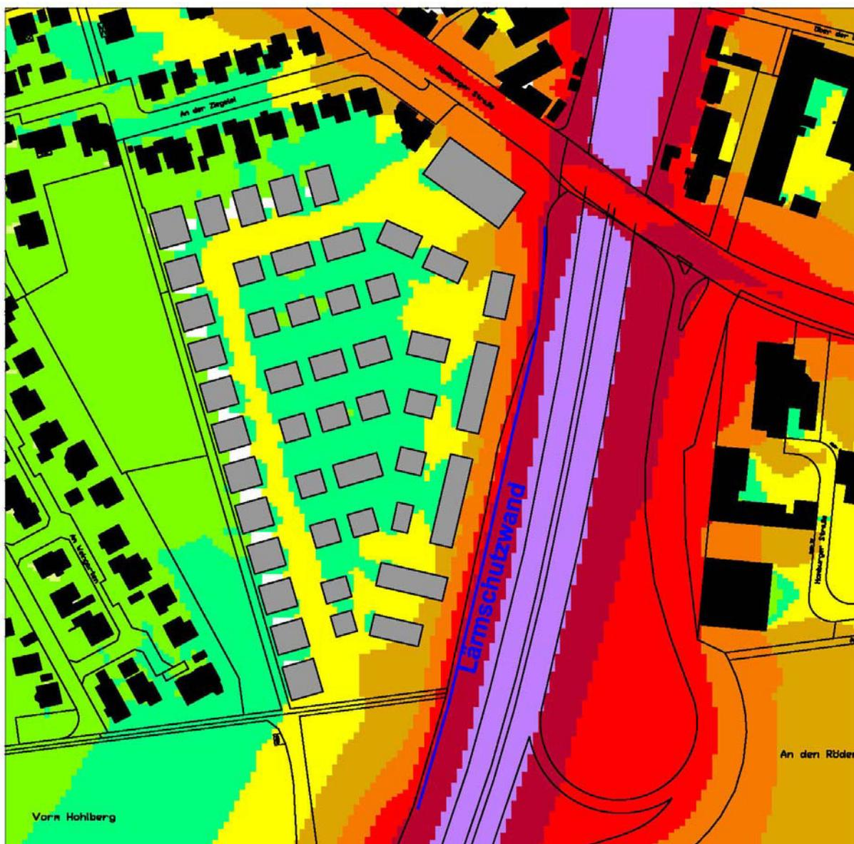
Abb. 7: Schallausbreitung nachts bei 4 m hoher Lärmschutzwand
