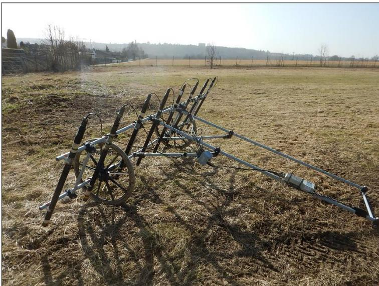
Die Messwerte werden zunächst im Datenlogger abgespeichert und später auf PC überspielt. Nach mehreren Bearbeitungsschritten lassen sich die Ergebnisse dann graphisch darstellen.
