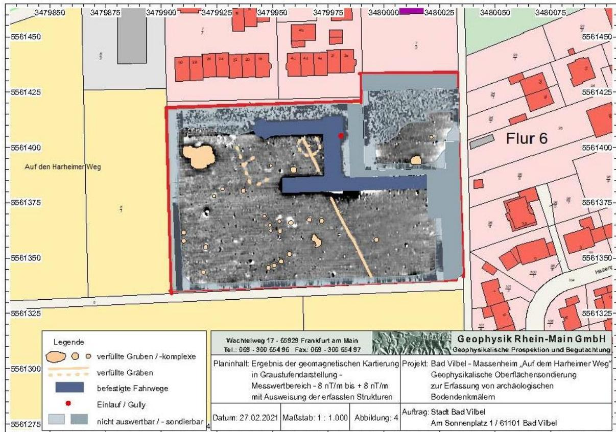
**Abbildung 23: Ergebnis der geomagnetischen Kartierung in Graustufenanstellung - Messwertbereich - 8 nT/m bis + 8 nT/m mit Ausweisung der erfassten Strukturen**
