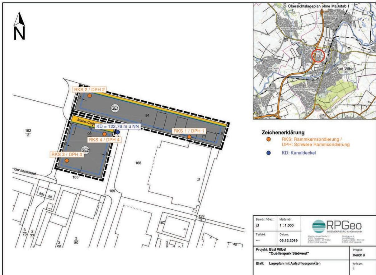
Abbildung 10: Lageplan mit Aufschlusspunkten<sup>k</sup>
