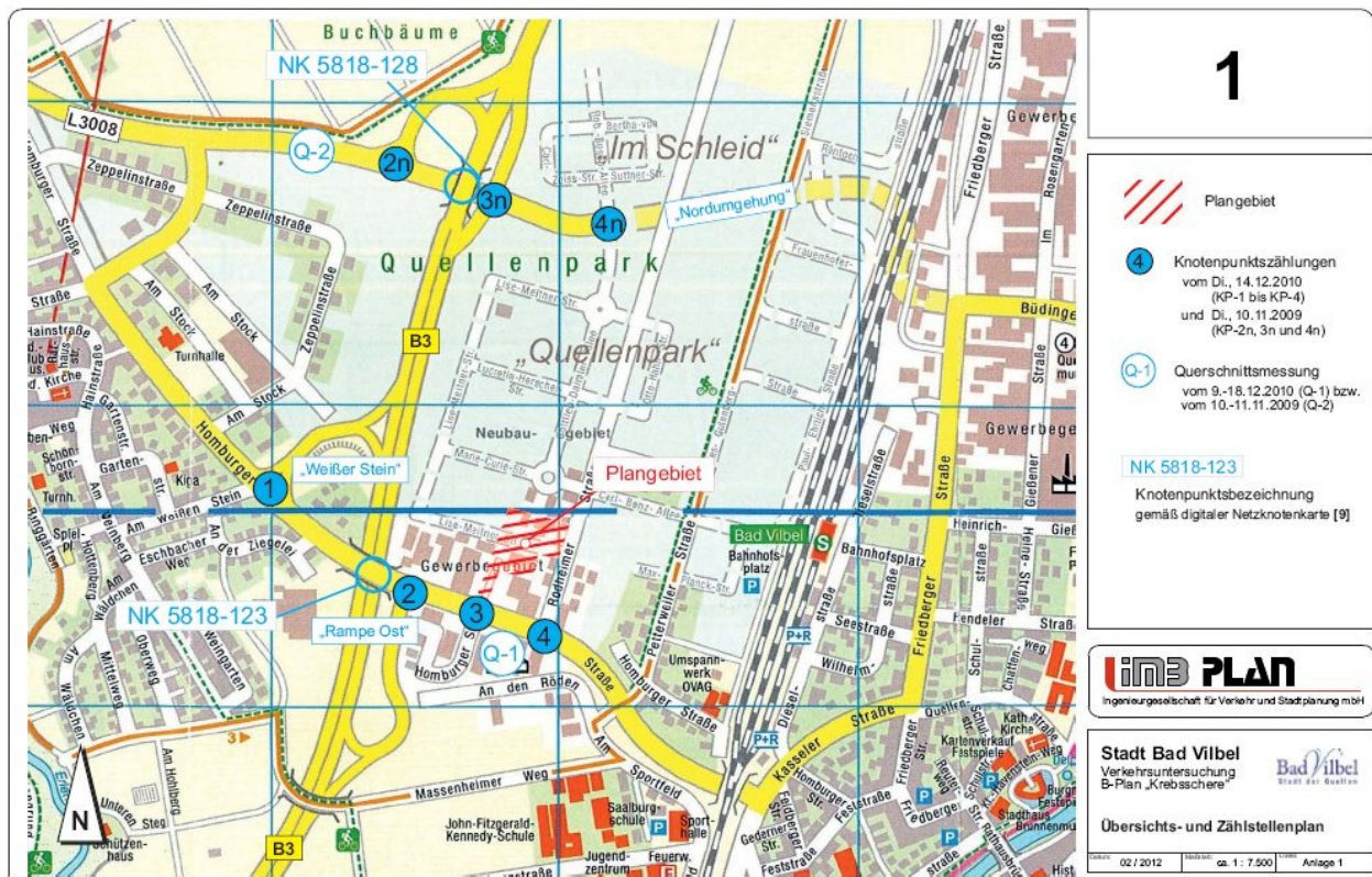
Abbildung 24: Übersichts- und Zählstellenplan zur Verkehrsuntersuchung im Rahmen der 3. Änderung und Erweiterung des Baugebieteplans „Krebschere“
